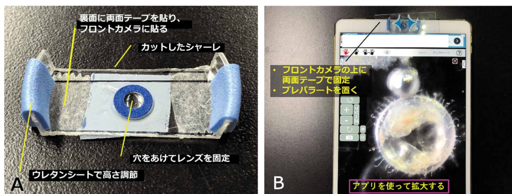
図2. ミエル1mmの試作品(A)とタブレットに取り付けた状態(B).
