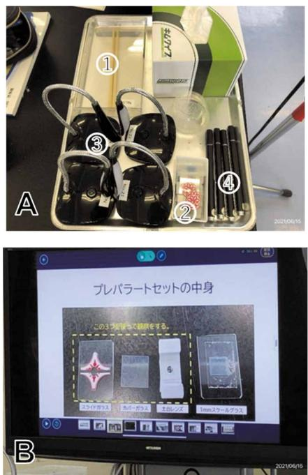
図4. A 各グループで用いる器具のセット。①保湿箱、②観察用プレパラート、③LED ライトスタンド、④タップチペン。B プレパラート作成と観察に必要な器具の説明。
