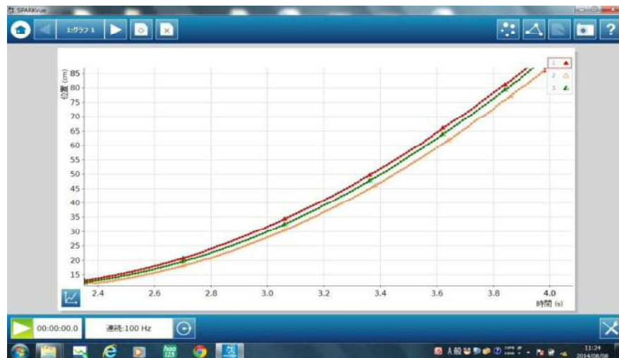
台車におもりを乗せ、質量を変えて測定した結果
