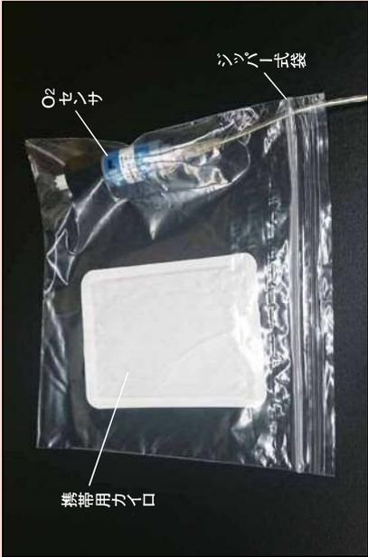
ジッパーのついた袋の中に、携帯用カイロと O<sub>2</sub> センサーを入れ、袋の中の酸素濃度を測定します。その後、時間とともに酸素濃度がどのようにに変化していったかを表したのが、下のグラフです。
