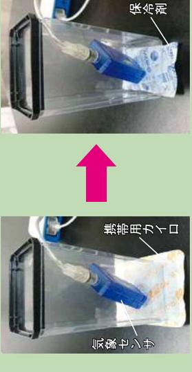
気象センサーを入れた容器の底に携帯用カイロを置き、空気をあたためます。その後、保冷剤で冷やし、気温と湿度がどのように変化するかをグラフで表しました。
