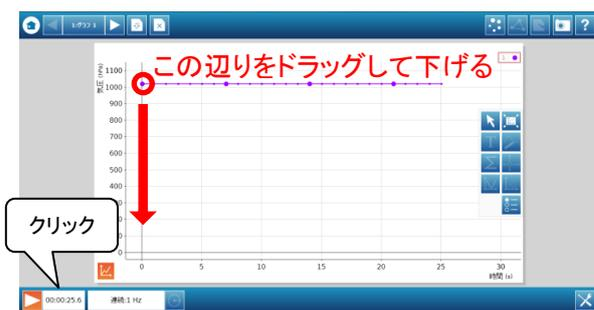
次に、測定開始付近のグラフをドラッグし、下に下げる（X=0の縦軸上であれば、どこでもよい）。これで、Y軸の最小値が変更される（Y軸の目盛で確認できる）。
